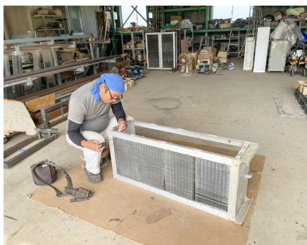
温室で使用するクーラー用ラジエーターを整備
